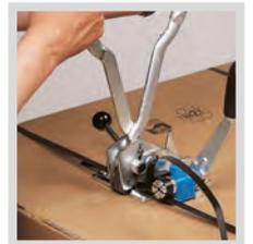
Umreifungsband einführen, an einer Seite fixieren, dann Verschlusshülse über das Band schieben und mit dem Werkzeug zusammendrücken. Zuletzt noch das Bandende abschneiden – fertig.
